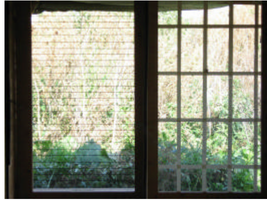
Abbildung 4: Die Markierungen „Plexi h schwarz“, Deckungsgrad 6,7% (links) und „Raster 10/20“, Deckungsgrad 24,2% (rechts) nebeneinander montiert. Die schwarzen Polyamid-Fäden in der linken Scheibe kontrastieren sowohl zum hellen als auch zum dunklen Hintergrund. Die weißen Klebebänder erscheinen im Streulicht des Tunnels in einem mittleren Grau und erzeugen mittlere Kontrastwirkung.
